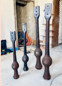
Die vier kleineren Klöppel sind bereits demontiert (16. März).
